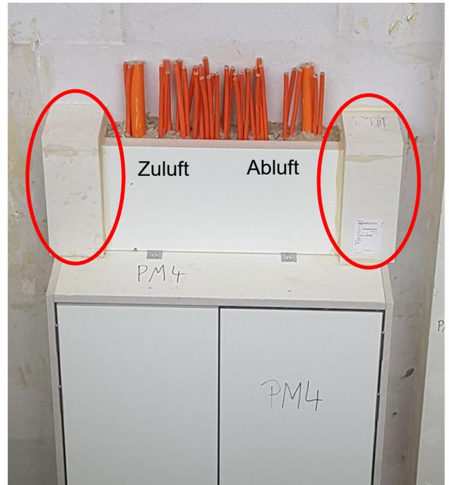
Bild 6: Brandschutzgehäuse (PM 4) mit aufgesetztem Standardbausatz für das Lüftungskanalstück L90/E190. Geprüft als „offenes System-eos“ (Lüftungsöffnungen im Brandfall offen)
