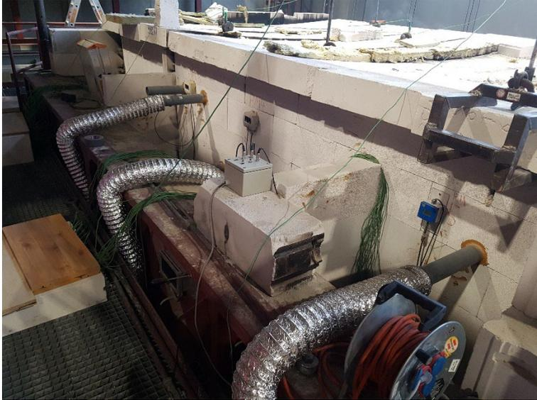
**Bild 12:** Anschlussleitungen zur Durchlüftung der Prüfkörper PM 4, PM 5 und PM 8
