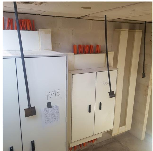
Bild 8: Prüfkörper PM 4, PM 5 und PM 8 im Brandprüfofen
