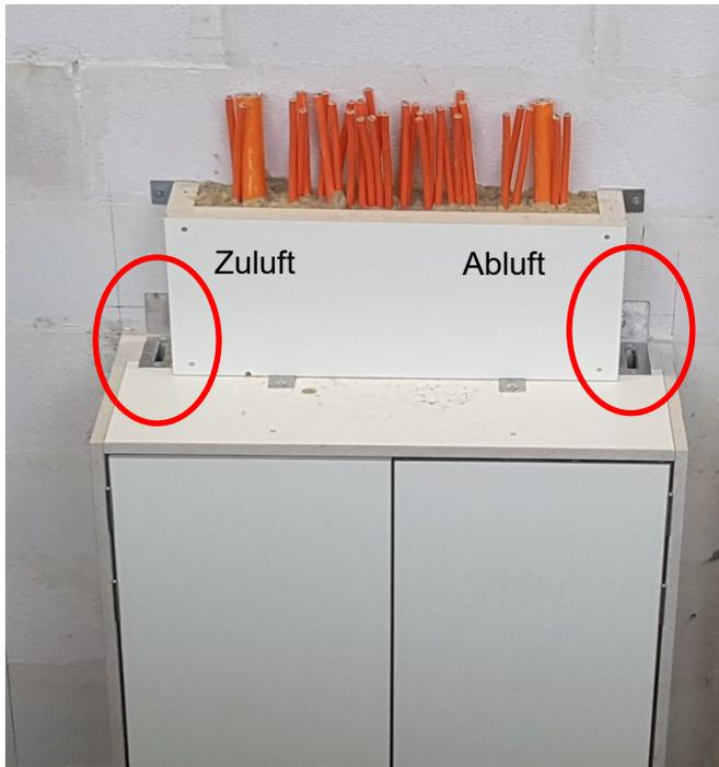
Bild 5: Brandschutzgehäuse (PM2) mit Zu- und Abluftöffnung (Standardanwendungsfall) als geschlossenes System geprüft (Lüftungsöffnungen im Brandfall geschlossen)
