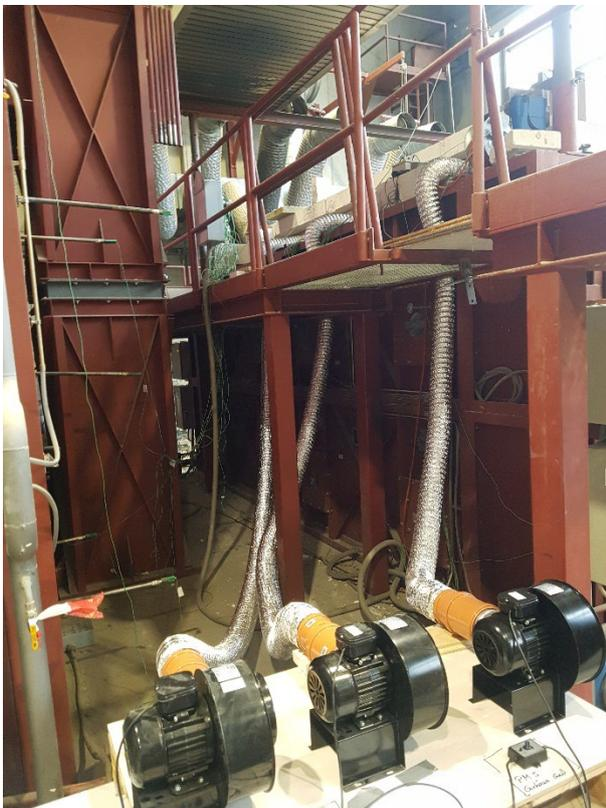
**Bild 13:** Radialgebläse zur Durchlüftung der Prüfkörper PM 4, PM 5 und PM 8
