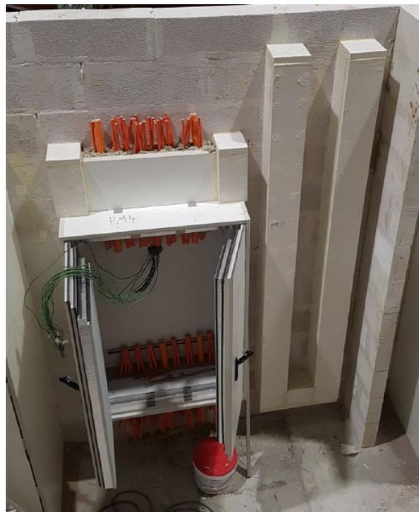
Bild 10: Prüfkörper PM 4 und L90/EI90 Lüftungskanal
